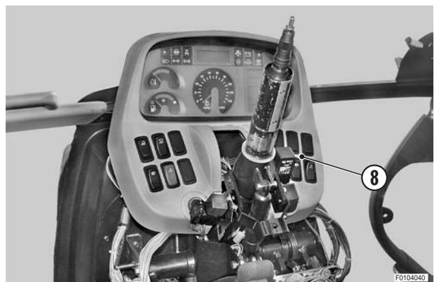
5 - Sélectionner la centrale HLHP. Ouvrir ensuite le menu "3.1.3 Entrées analog." et vérifier que la tension en sortie du capteur soit de  $0,8 \pm 0,1$  V, la pédale d'embrayage étant relâchée.
